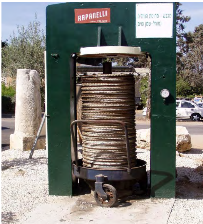
מתקנים למיצוי השמן מרסק הזיתים. הרסק נטען לתוך שקי עקלים, ונסחט בעזרת לחץ ברגי (מימין) או בשיטת הבוכנה (משמאל)
