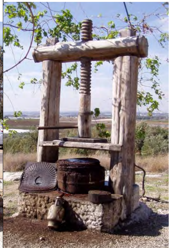
מתקנים למיצוי השמן מרסק הזיתים. הרסק נטען לתוך שקי עקלים, ונסחט בעזרת לחץ ברגי (מימין) או בשיטת הבוכנה (משמאל)
