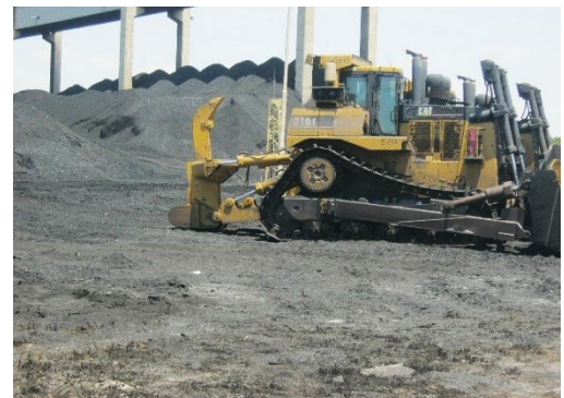
ד. הטרקטורים דוחפים את אבני הפחם אל תוך בור ומשם מובלים על מסוע אל המטחנות.
