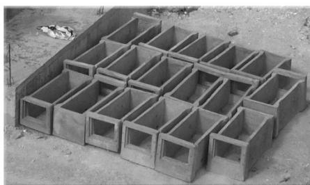
תמונה מס' 8 - כוכים העשויות ב'כלי' - אמבטיות מבטון סגורות מלמטה
